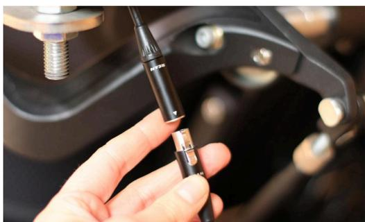
5. A conexão à cadeira é feita através de um cabo ligado diretamente à interface box. (Dependendo dos modelos de cadeira de rodas elétrica, os conectores podem ser diferentes; consulte o documento "Instalação da cadeira")
